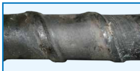
Schroef met afgesleten flanken en geruwde kern
