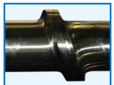
Nitreren, nabewerken, polijsten, richten en de plasticeerschroef is weer als nieuw
